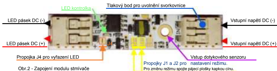
Obr.2 - Zapojení modulu stmívače
